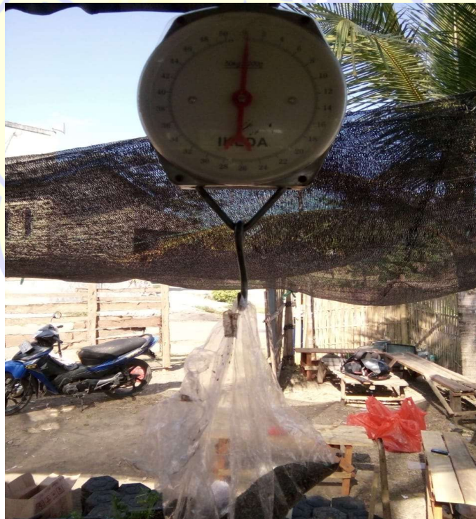
Gambar 13 : Proses penimbangan pasir dan limbah genteng
