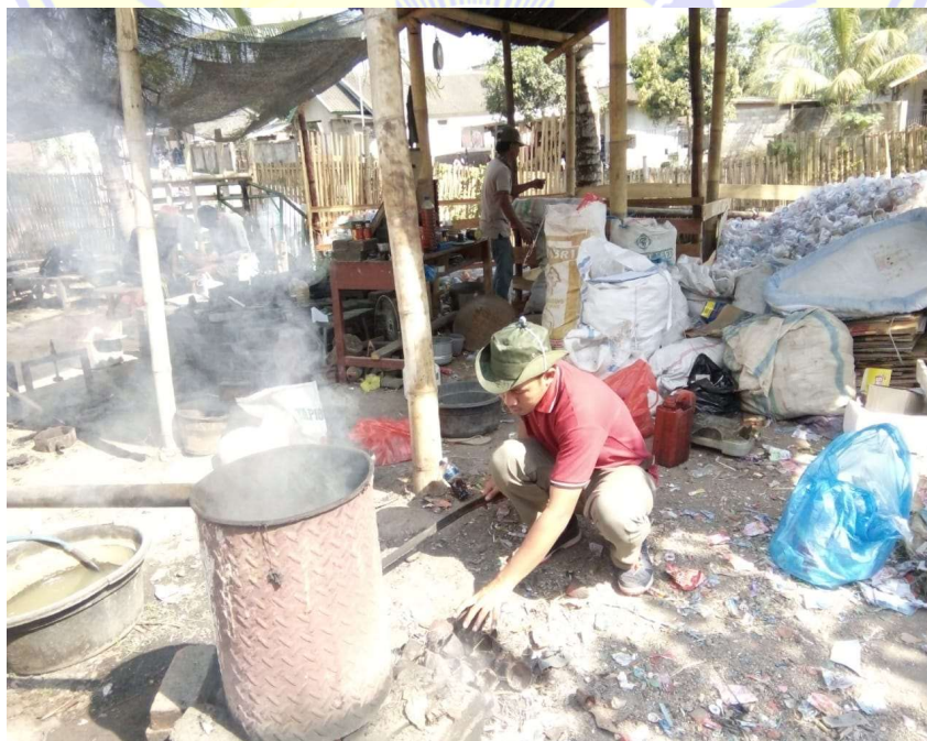
Gambar 18 : Proses pelelehan bahan uji paving block
