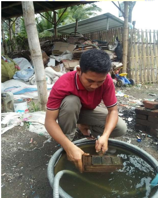
Gambar 20 : Proses pengepresan dan pembongkaran benda uji paving block
