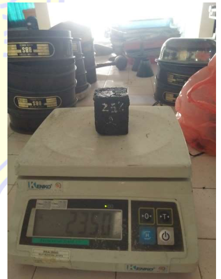
Gambar 22 : Proses penimbangan benda uji paving block untuk mendapatkan nilai berat
