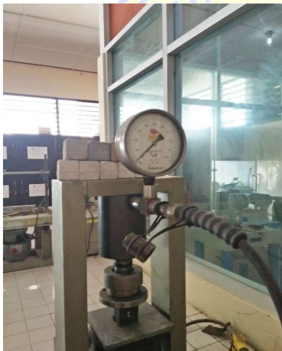
Gambar 23 : Proses pengujian kuat tekan benda uji paving block
