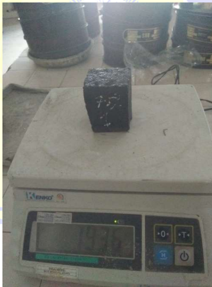
Gambar 22 : Proses penimbangan benda uji paving block untuk mendapatkan nilai berat
