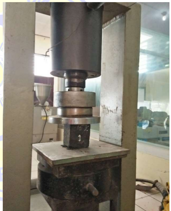
Gambar 23 : Proses pengujian kuat tekan benda uji paving block
