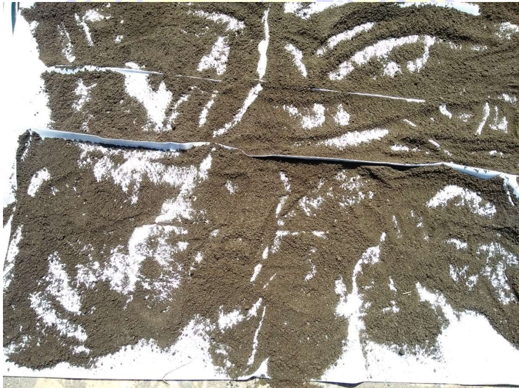
Gambar 3 : Proses penjemuran pasir selama 24 jam
