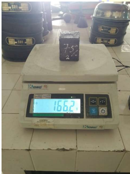
Gambar 22 : Proses penimbangan benda uji paving block untuk mendapatkan nilai berat
