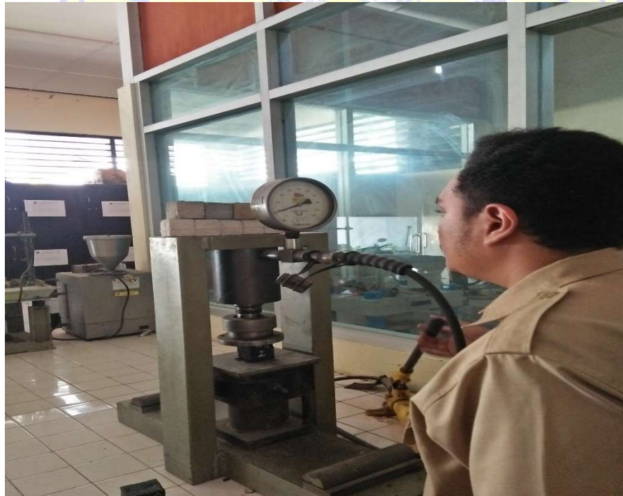
Gambar 24 : Proses pengujian kuat tekan benda uji paving block
