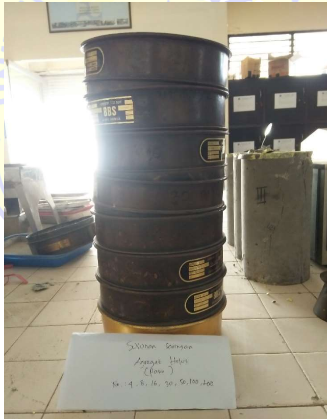
Gambar 4 : Saringan dan proses penyaringan agregat halus Sumber : Dokumentasi Penelitian
