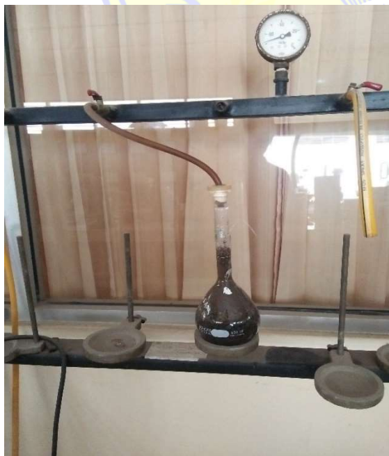
Gambar 3 : Proses pengujian berat jenis agregat halus
