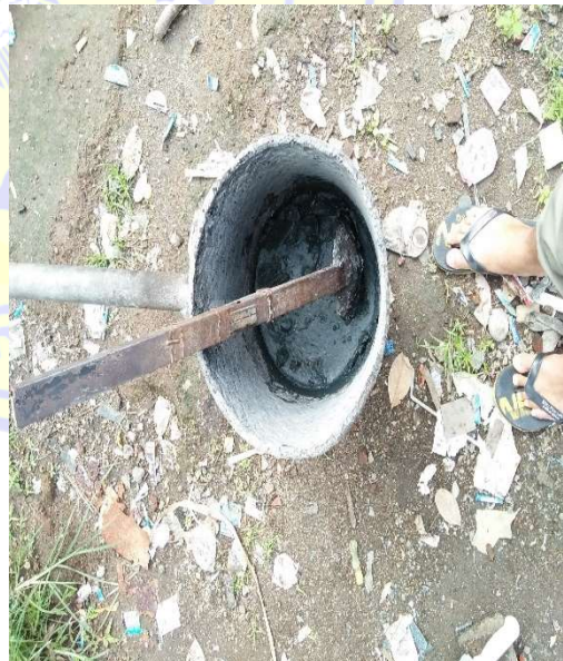
Gambar 19 : Proses pencampuran pasir dan hasil pelelehan bahan uji paving block
