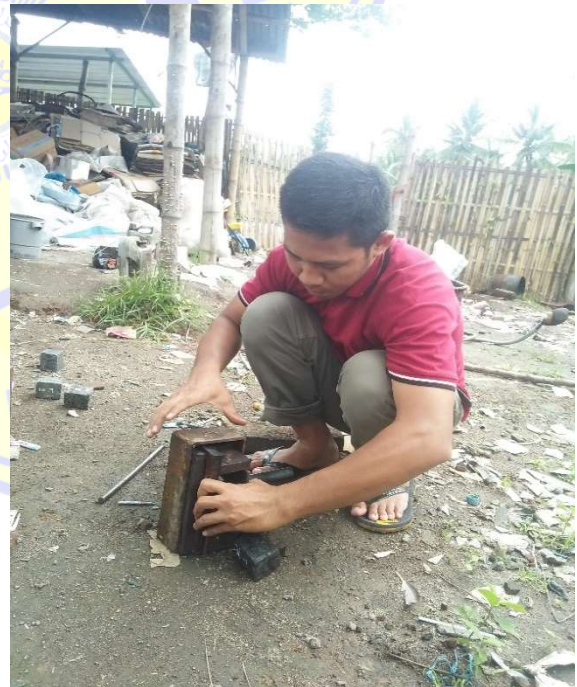
Gambar 20 : Proses pengepresan dan pembongkaran benda uji paving block
