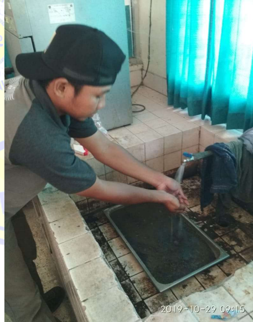
Gambar 3 : Proses pengujian berat jenis agregat halus
