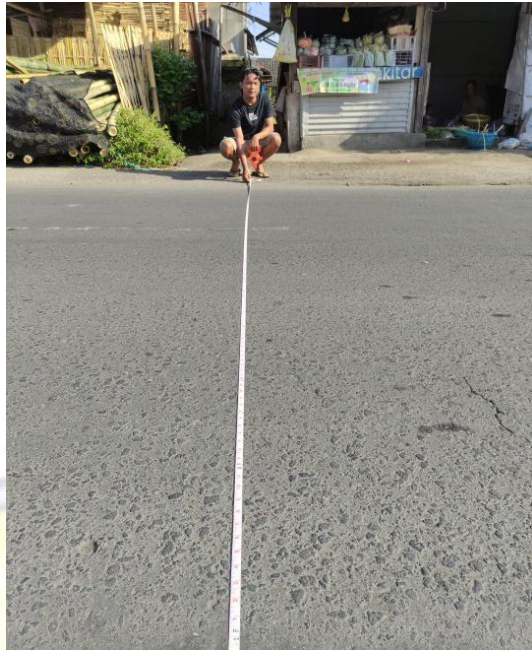
Gambar Pengukuran Lebar Jalan
