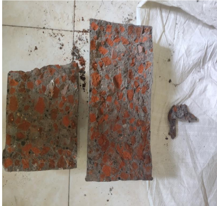
Gambar 4.7 beton dengan campuran limbah genteng 100%
