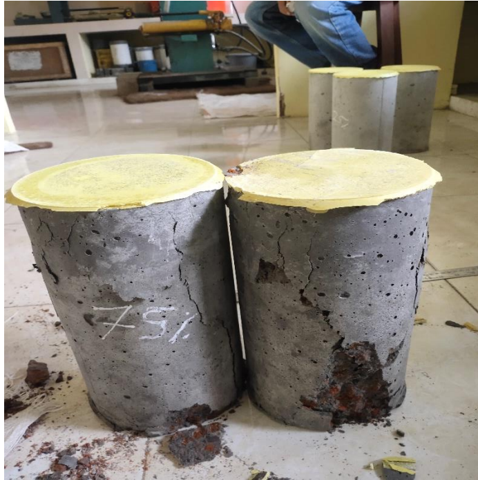
Gambar 4.6 beton dengan campuran limbah genteng 75%
