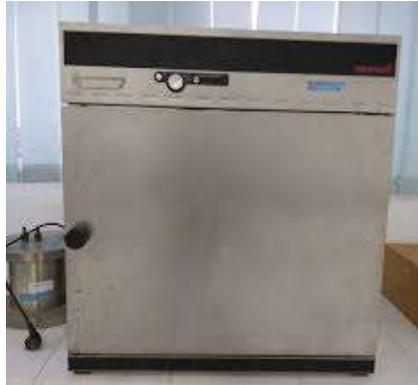
**Gambar 3.3** Oven Atau Pemanas Agregat
