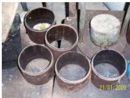
**Gambar 3.6** Cetakan Benda Uji (*Briket*)
