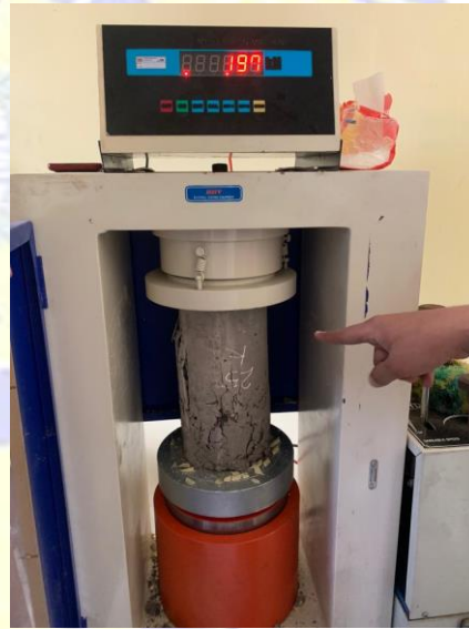
Pengujian Kuat Tekan Beton
