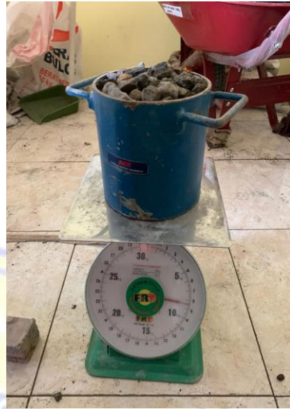
Pengujian Kepadatan Agregat Kasar
