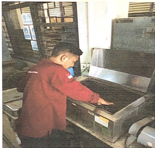
Gambar 8. Perendaman Benda Uji dalam Waterbath
