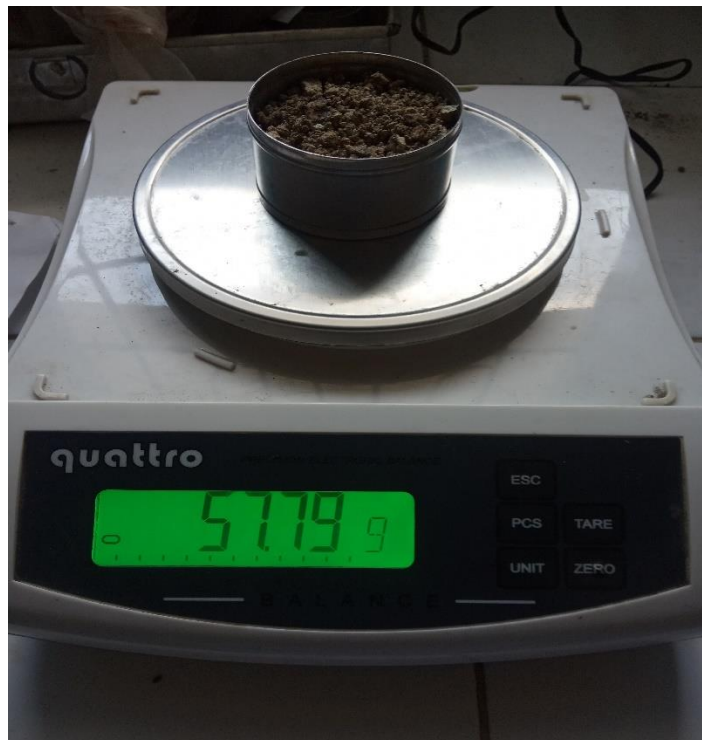
Dokumentasi pengujian kadar air
