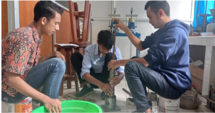
Dokumentasi pengujian pemadatan Proctor dan sama seperti pemadatan CBR
