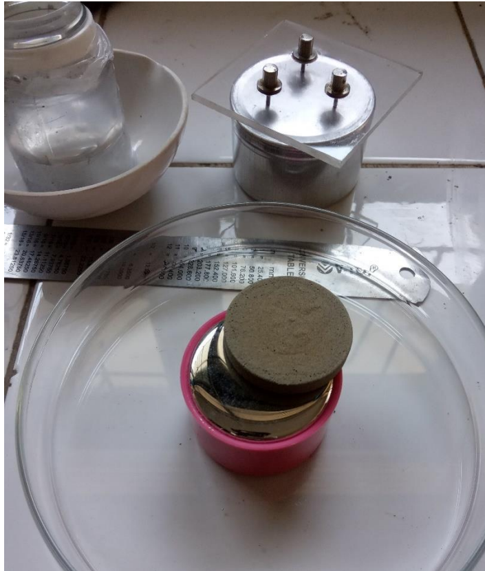
Dokumentasi pengujian batas susut dengan air raksa
