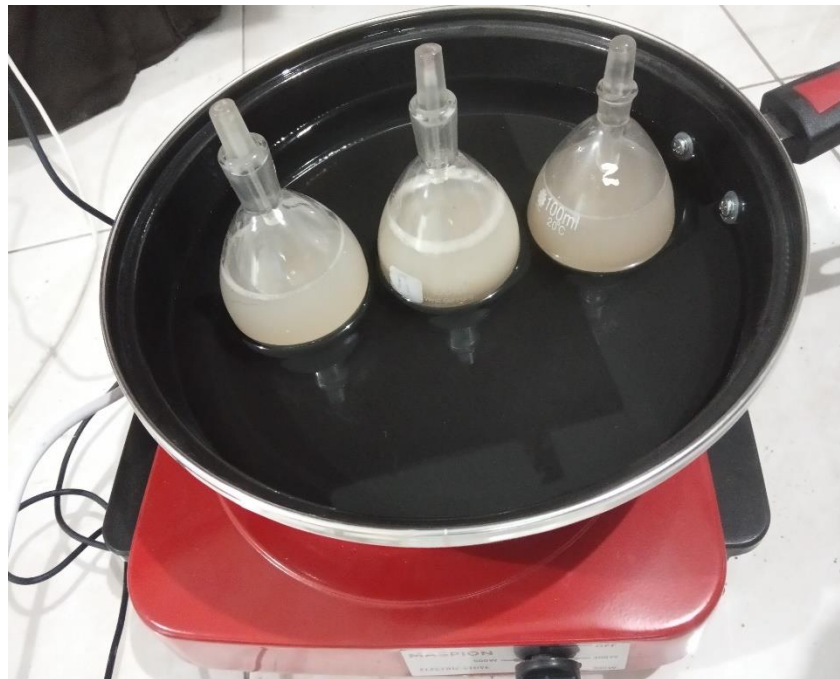
Dokumentasi pengujian berat isi tanah
