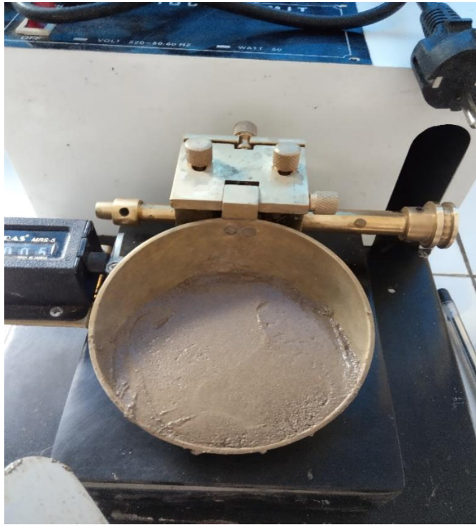
Dokumentasi pengujian batas cair
