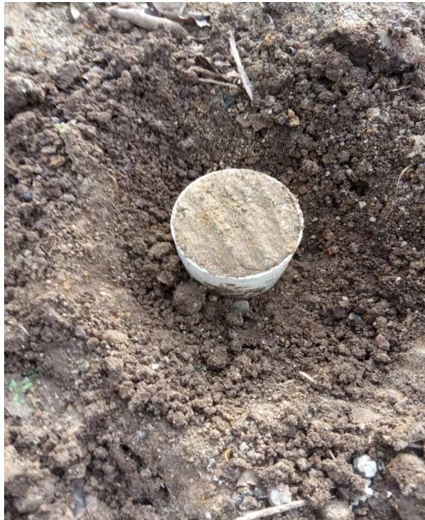
Dokumentasi pengujian berat volume tanah
