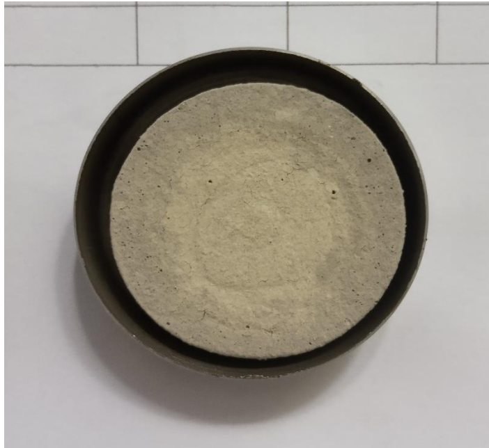
Dokumentasi pengujian batas susut
