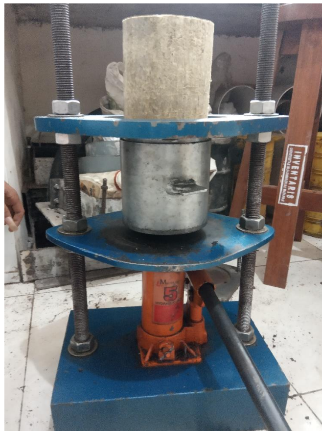
Dokumentasi Pengeluaran hasil pemadatan menggunakan extruder
