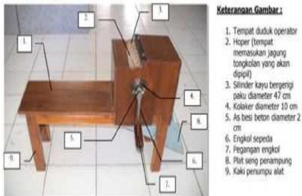
Gambar 8. Alat Pemipil Jagung Model Bangku
