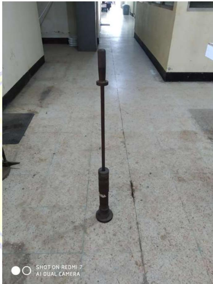
Gambar 3.3 Penumbuk benda uji
