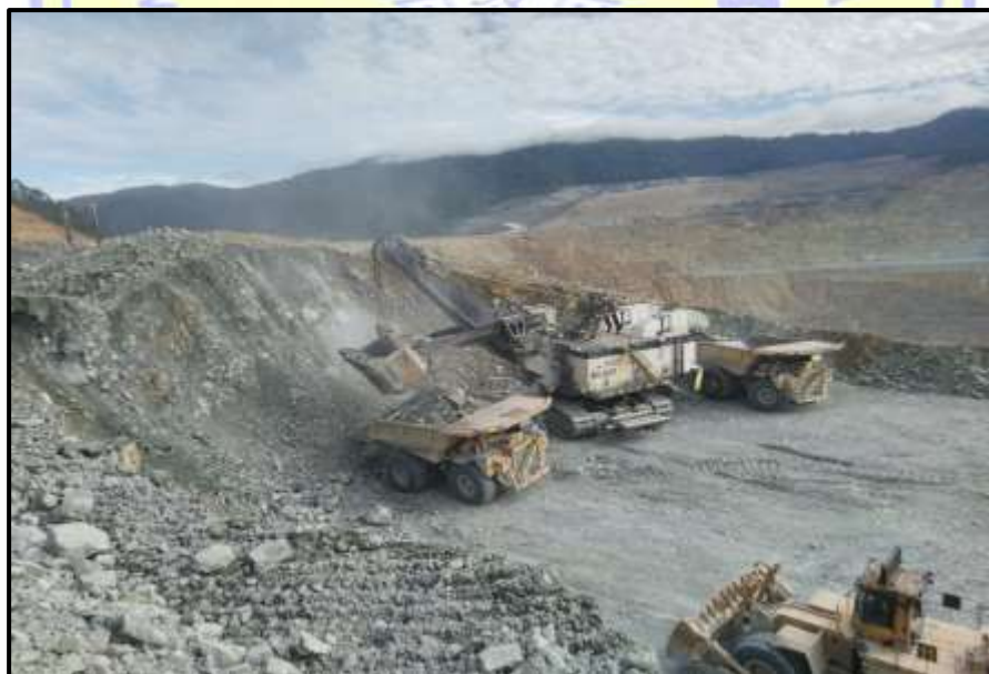
Gambar 12. Shovel P&H 4100A Melakukan Pemuatan
