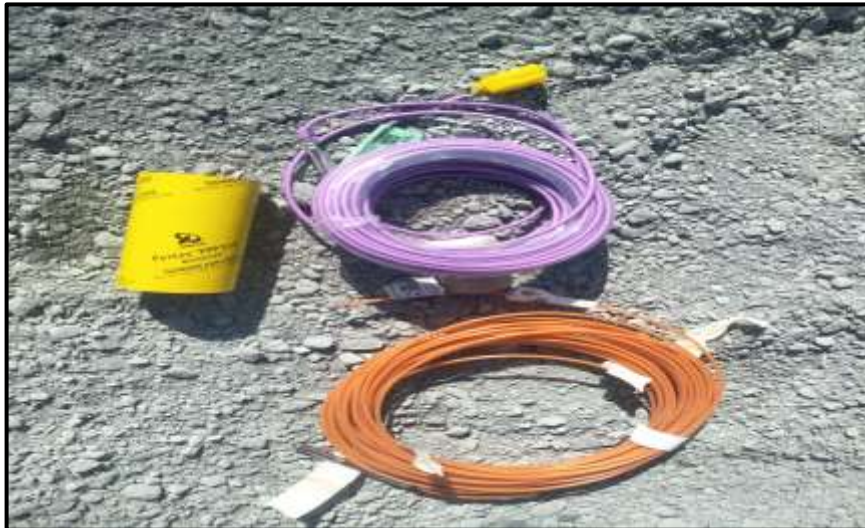
Gambar 10 Bosster, Nonel, dan Detonator (Sumber: Dokumentasi Pribadi 2019)
