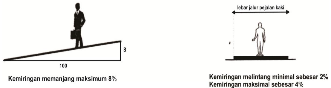
Sumber: Peraturan Menteri Pekerjaan Umum Nomor: 03/PRT/M/2014 Gambar 2.1: Kemiringan Jalur Pejalan Kaki
