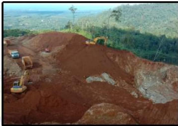
Gambar 2. 4 Kegiatan Pengupasan Lapisan Penutup(*OverburdenRemoval*)
