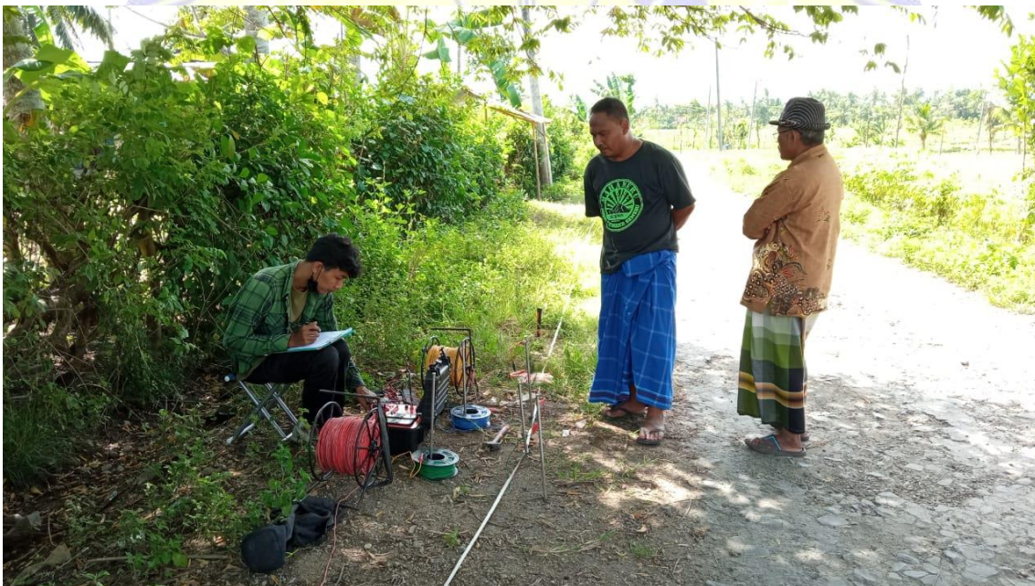
Penginjeksian menggunakan alat OJS Resistivity Meter V- RM 0219 pada Titik Lokasi Olor 2 disaksikan oleh Kepala Dusun Olor Agung
