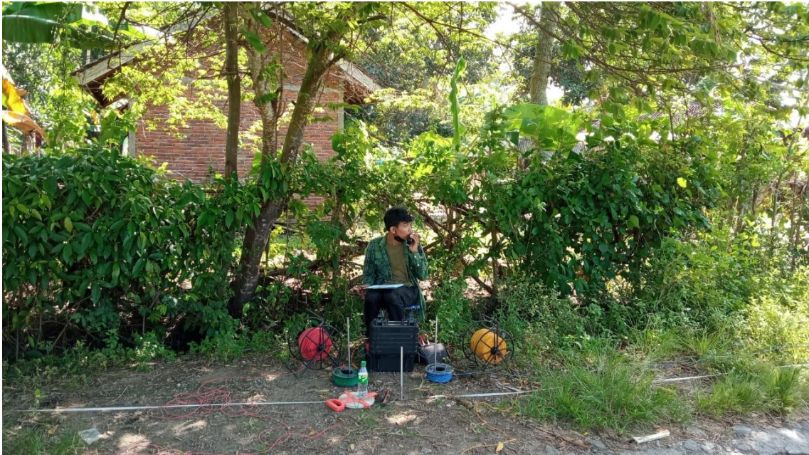
Proses memastikan seluruh elektroda sudah terhubung sebelum penginjeksian Titik Olor 2
