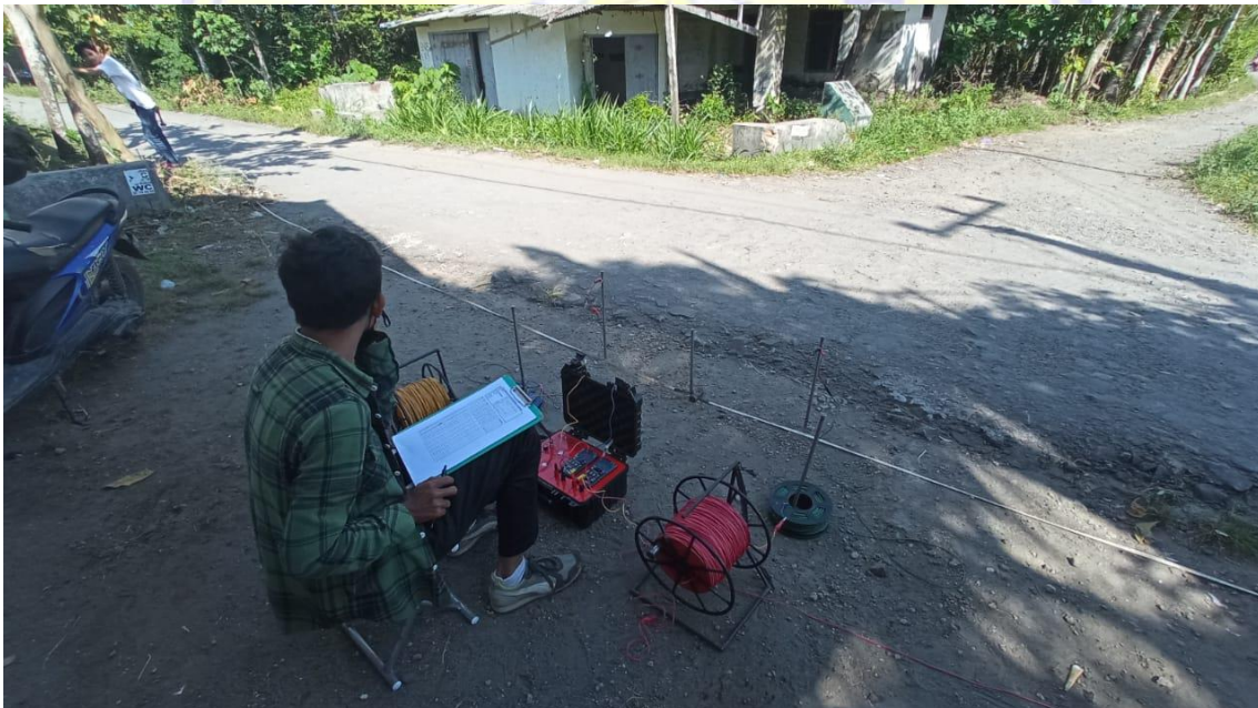
Proses memastikan seluruh elektroda sudah terhubung sebelum penginjeksian Titik Olor 1
