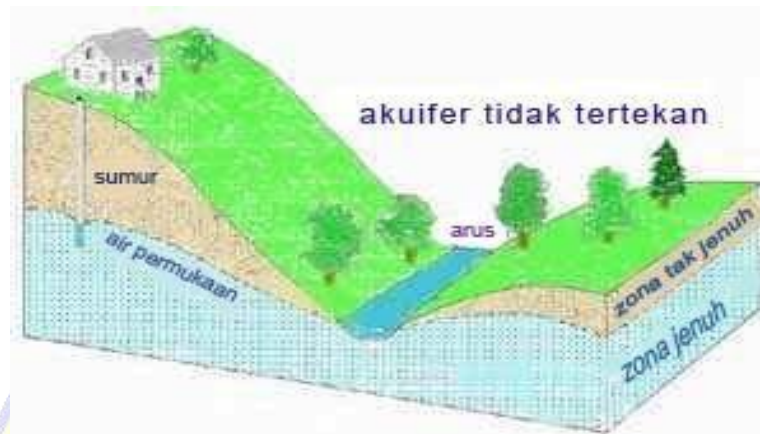
Gambar 2. 4 Akuifer bebas atau akuifer tidak tertekan (Wuryantoro, 2007)
