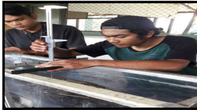
Gambar 3.8 Uji Dasar Flume Tidak Tetap
