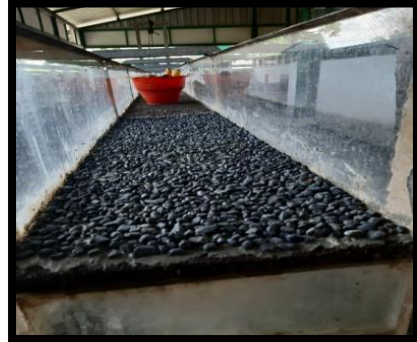
Sumber : Laboratorium Hidrolika UMMAT, 2021 Gambar 3.6 Dasar Tidak tetap, (a) Proses Penumpahan dan (b) Proses perataan permukaan.
