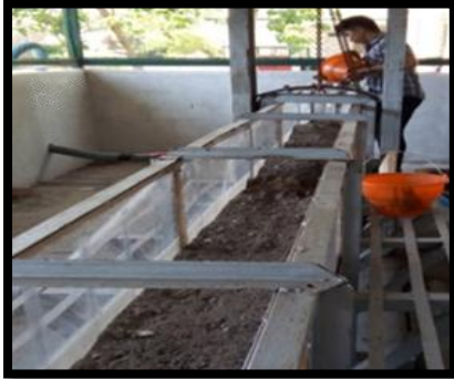
Sumber : Laboratorium Hidrolika UMMAT, 2021 Gambar 3.6 Dasar Tidak tetap, (a) Proses Penumpahan dan (b) Proses perataan permukaan.
