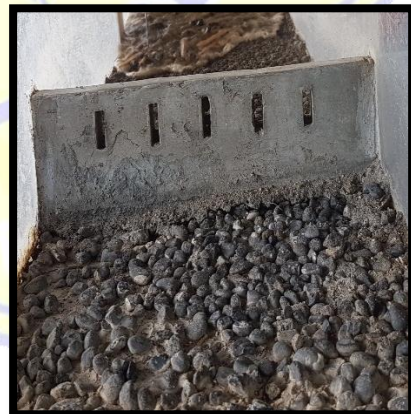
Gambar 3.7 Model Sabo dam, Tampak atas, dan Tampak depan
