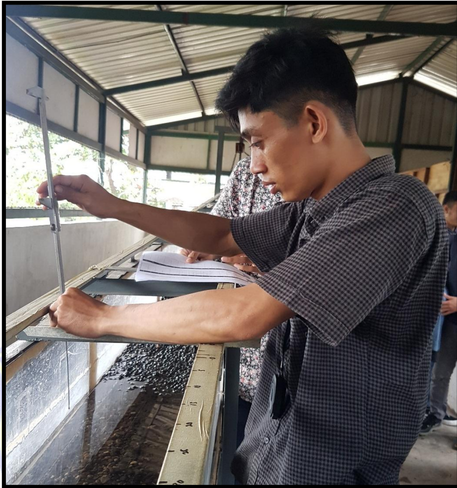
Gambar 3.11 Uji Dasar Flume Tidak Tetap
