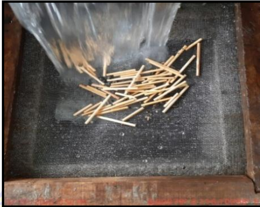
Gambar 3.9 Perlengkapan Penelitian Saringan kayu ukuran 40 cm x 40 cm.
