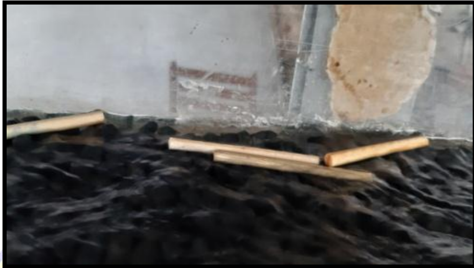
Gambar 3.25 Kayu yang Tertahan di Dinding flume
