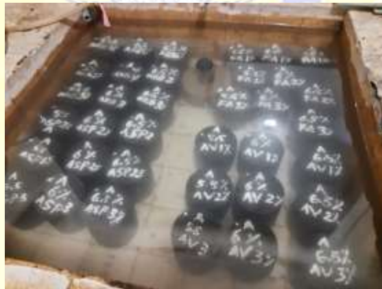
Proses perendaman benda uji untuk mencari nilai SSD
