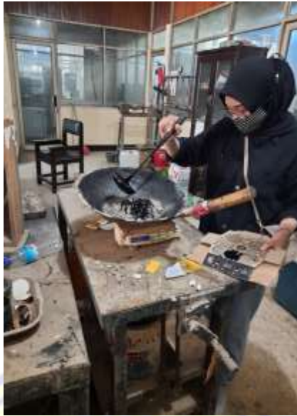
Menambahkan material aspal kedalam agregat sesuai kadar aspal yang ditentukan
