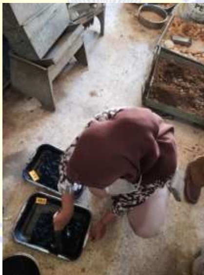
Menghancurkan benda uji yang telah di masukkan kesalam oven
