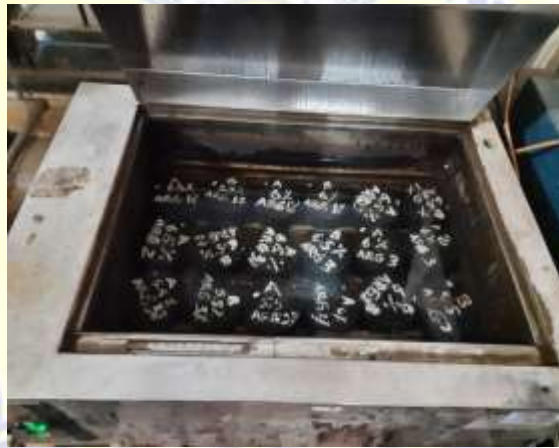
Proses perendaman di alat water bath dengan suhu 60^{\circ}
