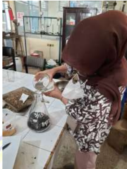
Memasukkan air aquadem kedalam picnometer yang berisi benda uji yang telah dihancurkan
