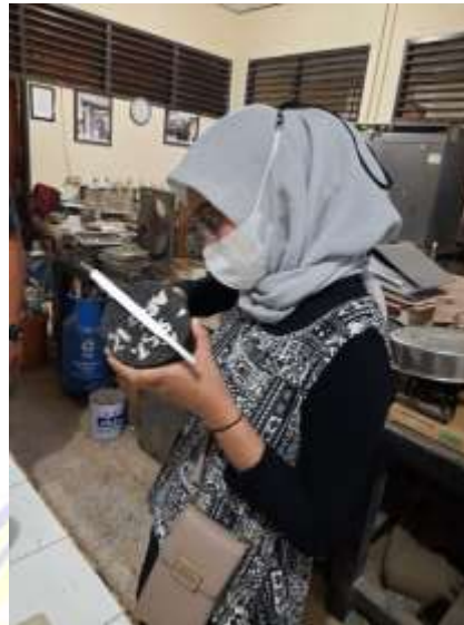
Megukur tebal benda uji
