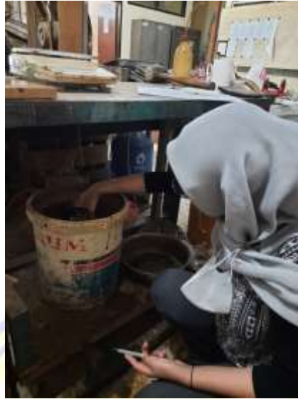
Menimbang benda uji dalam air
