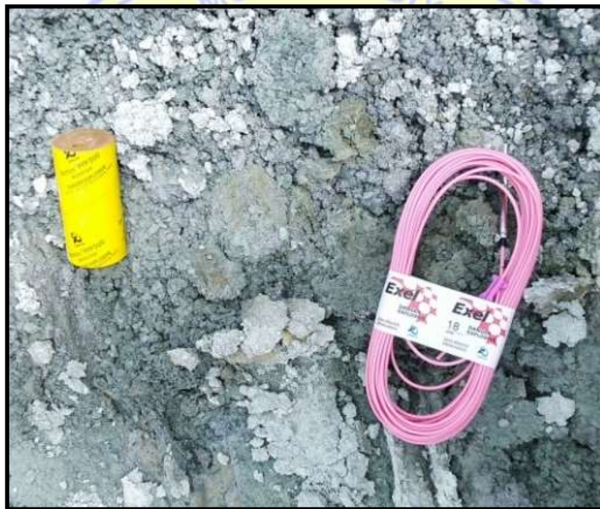
Gambar 2.11 Booster 400 gram dengan Nonel Tube 18 meter
