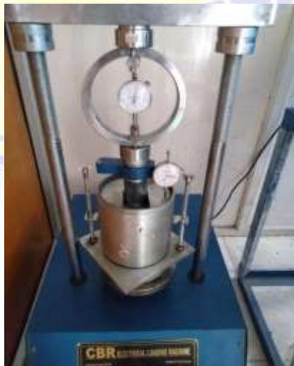
Gambar 3.15 Alat penguji Penetrasi CBR laboratorium
