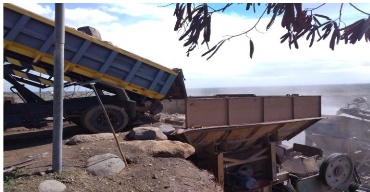
Gambar 2.6 Dump Truck Menumpahkan Batu Andesit Ke Hopper
