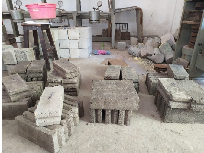
Dokumentasi 4. Tahap pengujian batako normal dan batako tailing 15%,30%, dan 50%.
