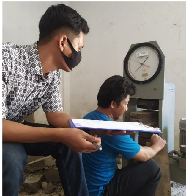
Dokumentasi 5. Tahap pengambilan data kuat uji tekan batako normal dan batako tailing 15%,30%,dan 50%.
