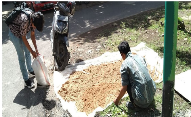
Dokumentasi 2. Tahap pengeringan tailing pertambangan.
