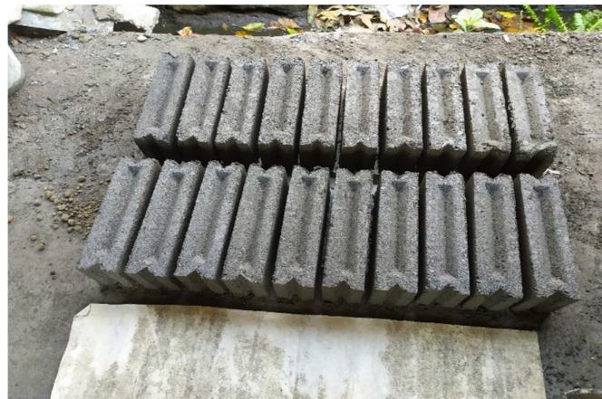
Dokumentasi 3. Tahap pengeringan batako normal dan batako tailing 15%, 30%, dan 50%.
