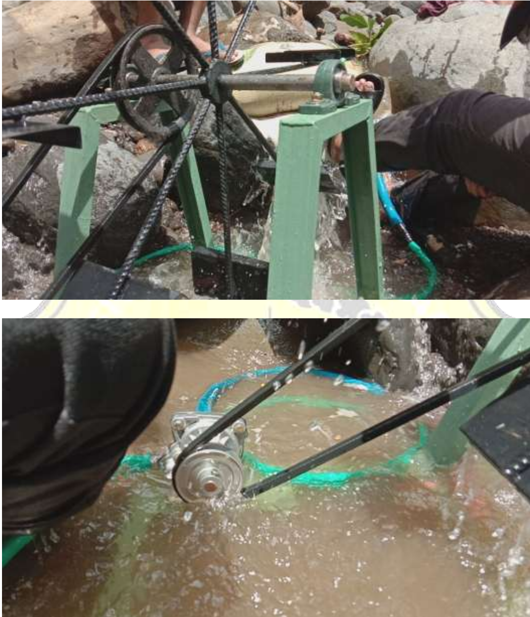
Gambar 3. Alat turbin air Sebagai penggerak pompa sentrifugal
