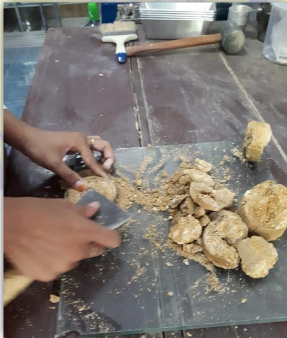
Persiapan sampel uji Geser Langsung
