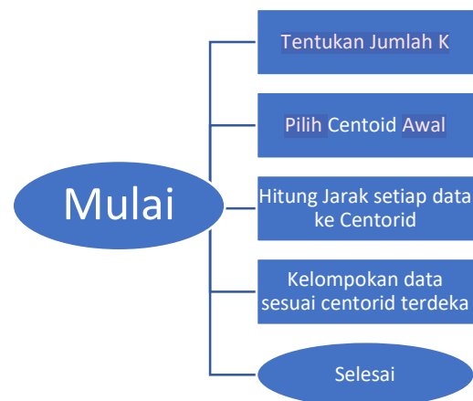
Keterangan Gambar 2.1: diagram alir cara kerja K-Means
