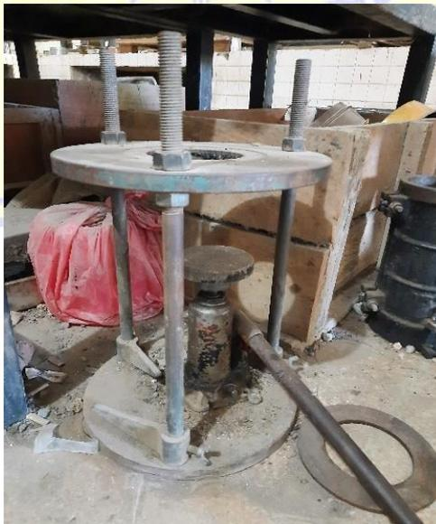
**Gambar 3.8** Alat pengangkat *briket* ( dongkrak hidrolis ).
