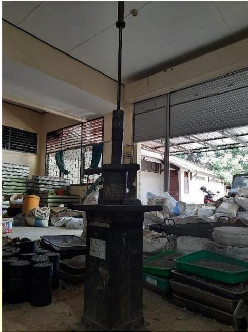
**Gambar 3.7** Alat penumbuk (*compactor*).
