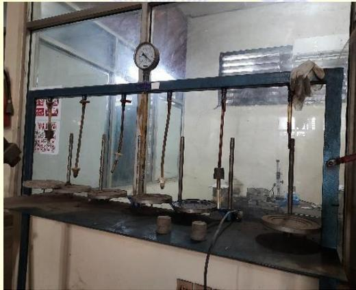
**Gambar 3.2** Alat pengujian volumetrik
