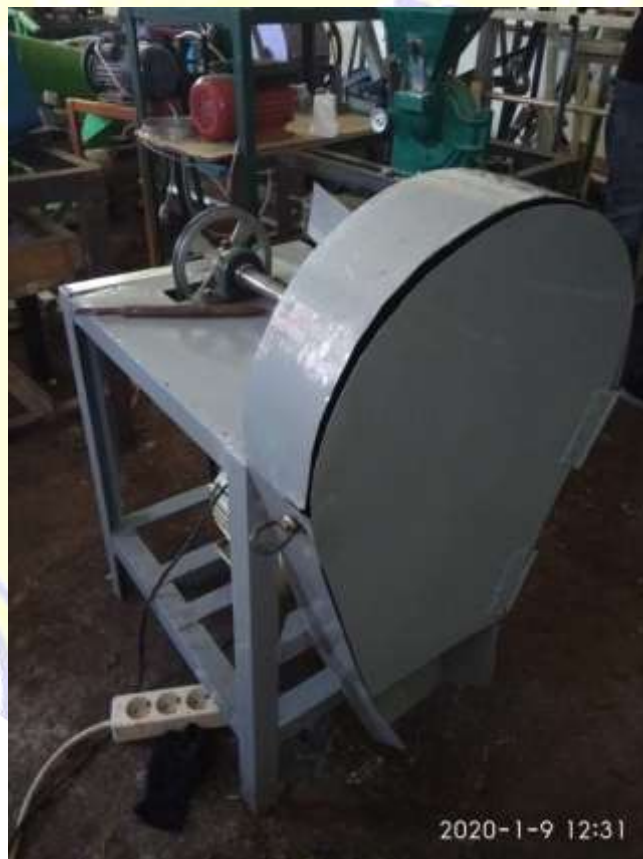
Lampiran 6. Gambar mesin perajang daun tembakau yang telah dirakit.
