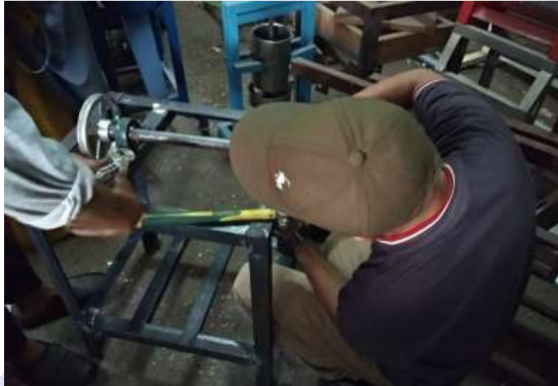
Lampiran 9. Proses pemasangan poros dan pully
